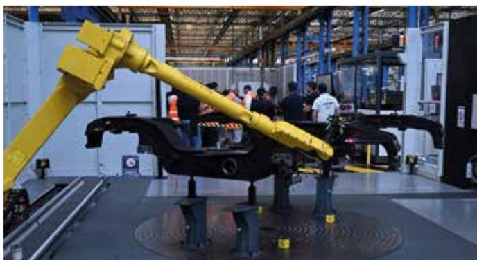
guré. Il s'agit d'un robot qui permet de scanner, avec la technologie du laser, les châssis des bogies, pour tendre vers le zéro défaut.
